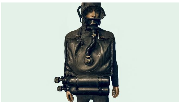
Figure 12 Italiensk (Salvas) sirkulasjonsapparat (rebreather) fra 1950 for bruk av militære angrepssvømmere. Pustegassen
